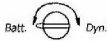
Bild 3. Umschalter in Stellung „Batterie“
