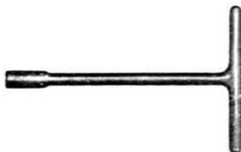
Num. matr. 49520 Chiave a tubo per tendicatena e manettini di comando
