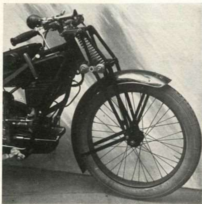
Forcella "Tiger", F. G. 4 adattata ad una moto Guzzi — APPLICAZIONE IN 20 MINUTI —
