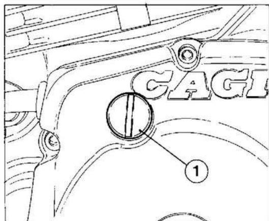
1 Tappo controllo fase - Plug for timing inspection hole - Bouchon de contrôle phase - Stopfen zur Phasenkontrolle
