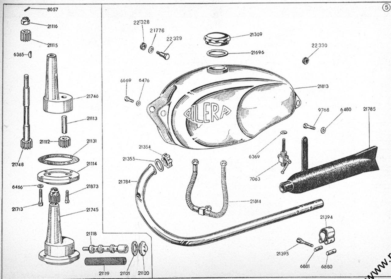
Tav. 5 — MOTORE - Pompa olio e filtro - Serbatoio - Tubo scarico e silenziatore
