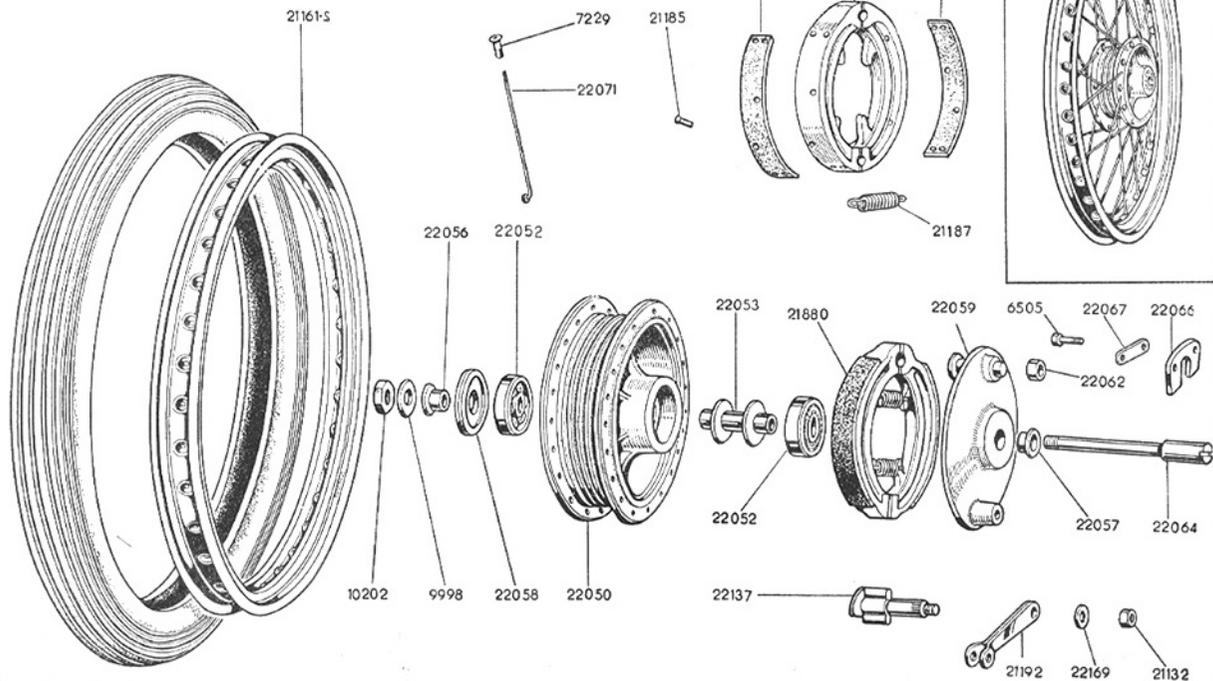
Tav. 12 — MOTOTELAIO - Ruota posteriore freno e comando (Sport 4 velocità)
