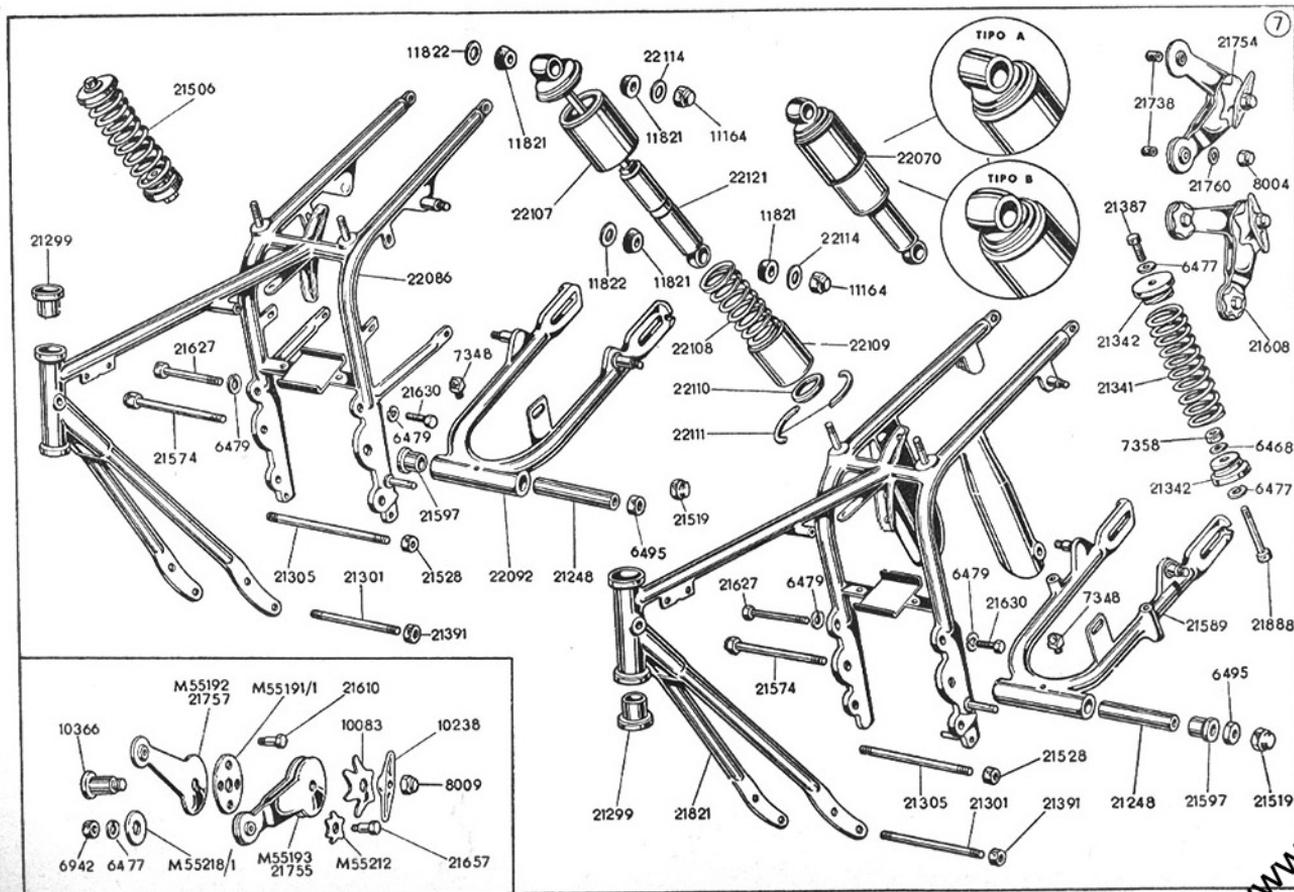
Tav. 7 — MOTOTELAIO - Telaio - Sospensione posteriore
