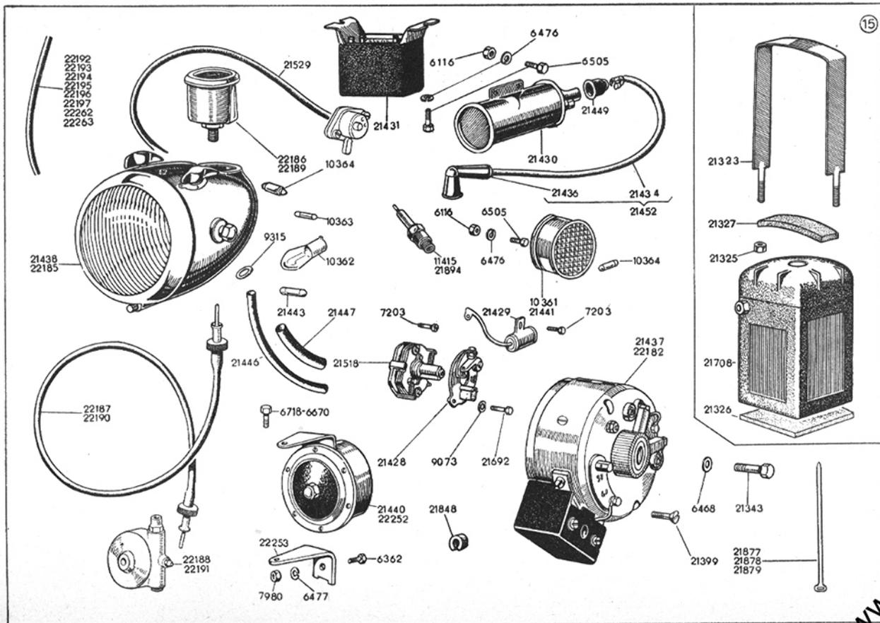
Tav. 15 — IMPIANTO ELETR. E ACCESSORI - Spinterogeno - Batteria - Fanaleria e sue parti - Connessioni - Contachil.
