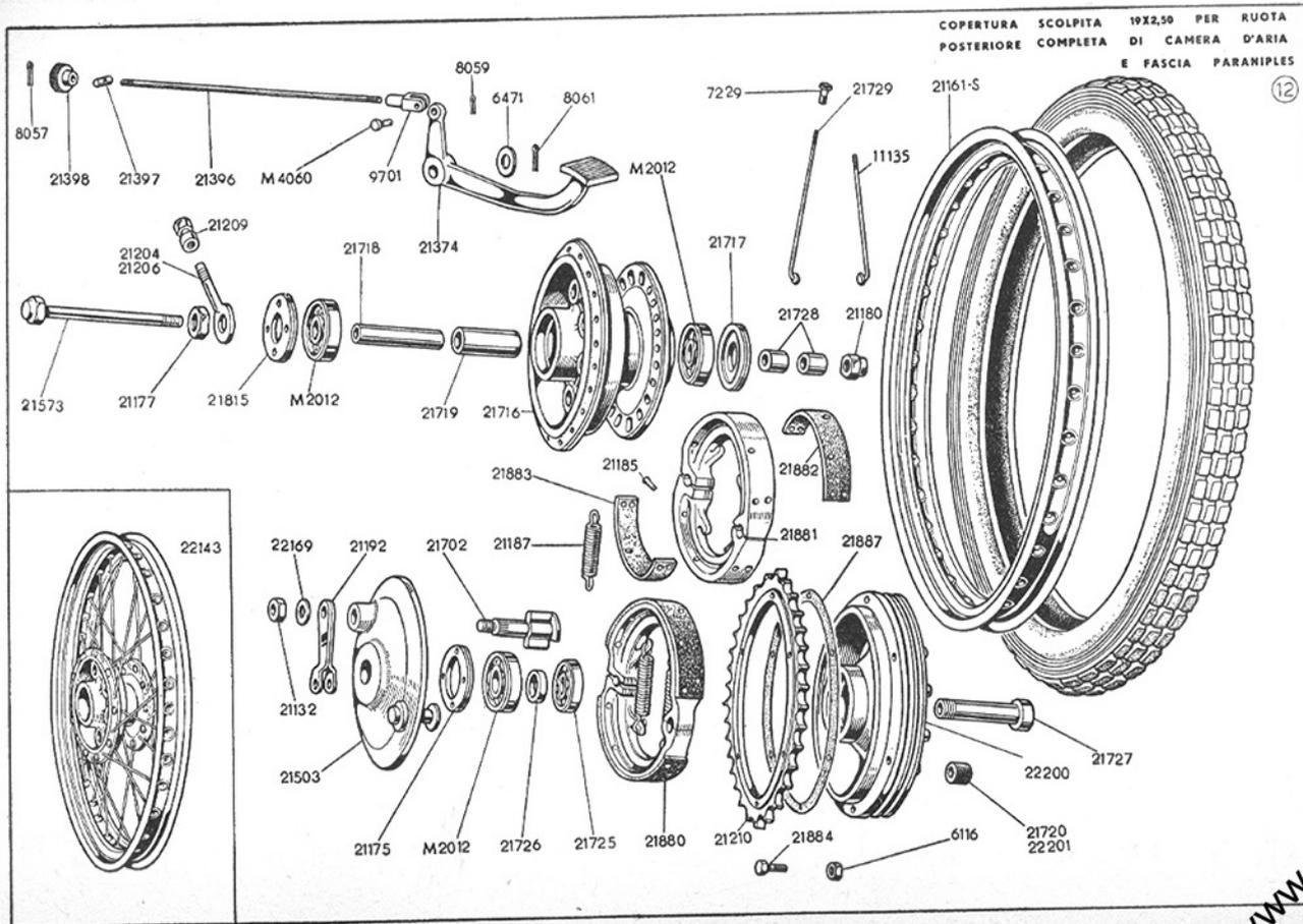
Tav. 12 — MOTOTELAIO - Ruota posteriore freno e comando (Sport 4 velocità)
