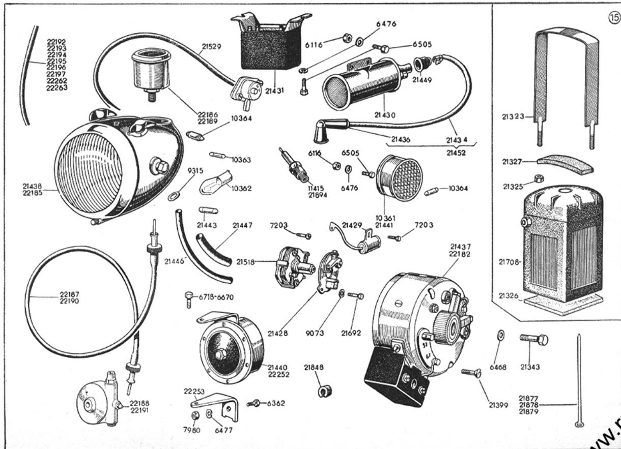
Tav. 15 — IMPIANTO ELETTR. E ACCESSORI - Spinterogeno - Batteria - Fanaleria e sue parti - Connessioni - Contachil.
