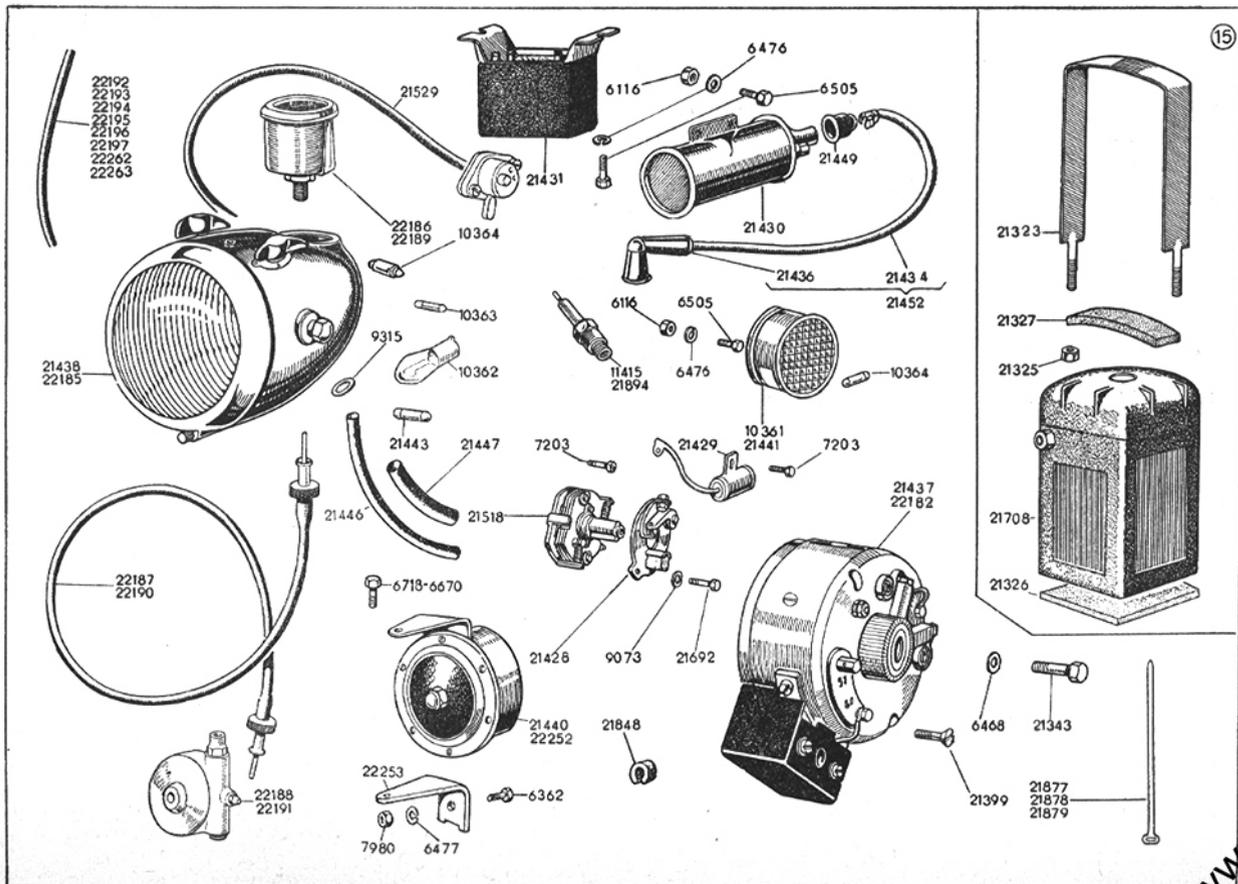
Tav. 15 — IMPIANTO ELETTR. E ACCESSORI - Spinterogeno - Batteria - Fanaleria e sue parti - Connessioni - Contachil.
