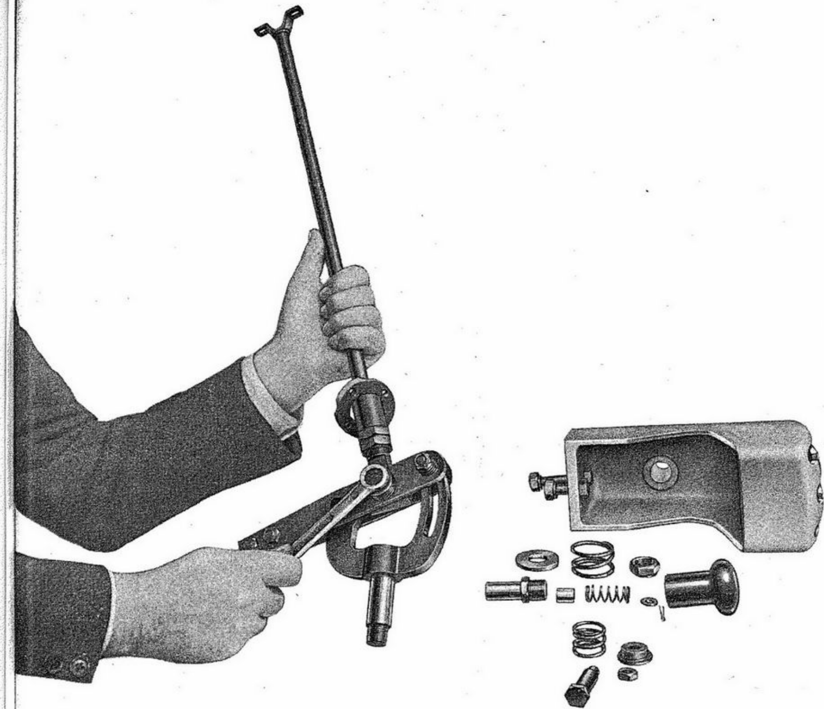
Fig. 40 - Smontaggio della leva di comando cambio velocità
