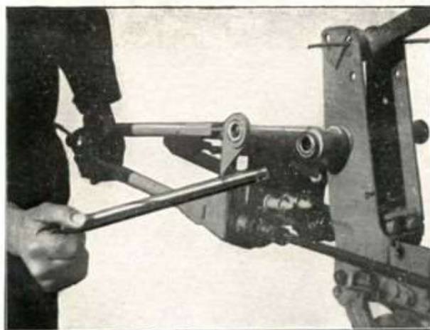
Fig. 28 - Come si leva il forcellone oscillante completo e i tiranti.
