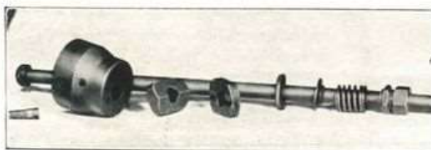
Fig. 86 - Da sinistra a destra: Uno dei 5 bulloncini, la scatola e i blocchetti maschio e femmina. Infilati nel tirante: la ranella di cuoio, il piattello, la molla e il morsetto di fissaggio.
