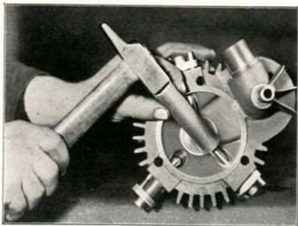
Fig. 52 - Come si levano i paravalvola, quello al basso a sinistra è già stato rimosso.
