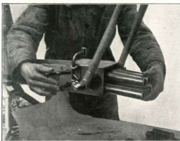
Fig. 27 - Come si levano le due cremagliere e il gruppo tubi reggi molla.
