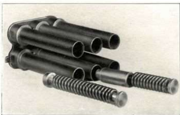
Fig. 84 - Moto biposto. Si notino lo spessore, la molla e la bussoletta di pressione laterali (a sinistra) e centrali.
