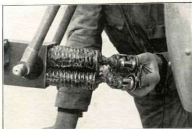
Fig. 23 - Piastra premimolle appena levata.
