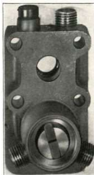
Fig. 72 - Il corpo pompa visto dall'esterno. È visibile la pompa di ricupero a palette scorrevoli.
