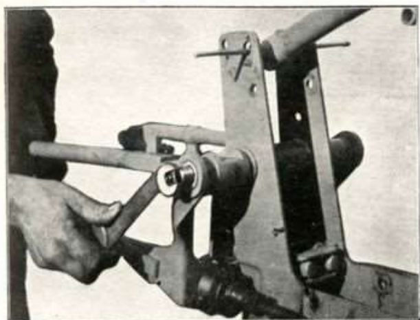
Fig. 26 - Come si leva il perno principale del forcellone oscillante.
