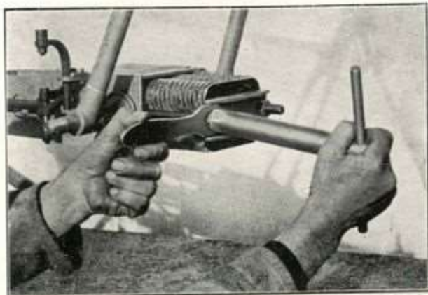
Fig. 21 - Come si leva la piastra premimolle.
