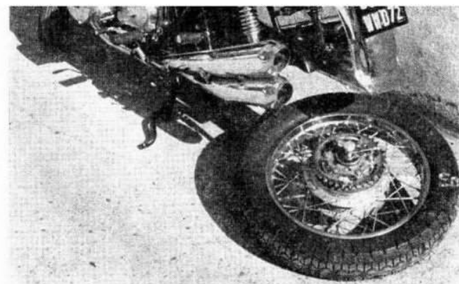
La dépose de la roue arrière de la Kawasaki 900 nécessite la dépose de la chaîne secondaire de la couronne arrière (Photo RMT)
