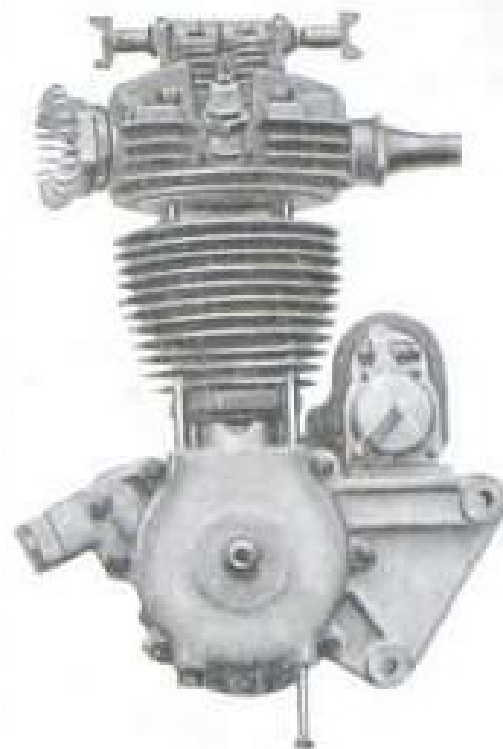
Smontaggio del cilindro e della testa. I tiranti di bloccaggio si sfilano dalla parte inferiore del carter.
