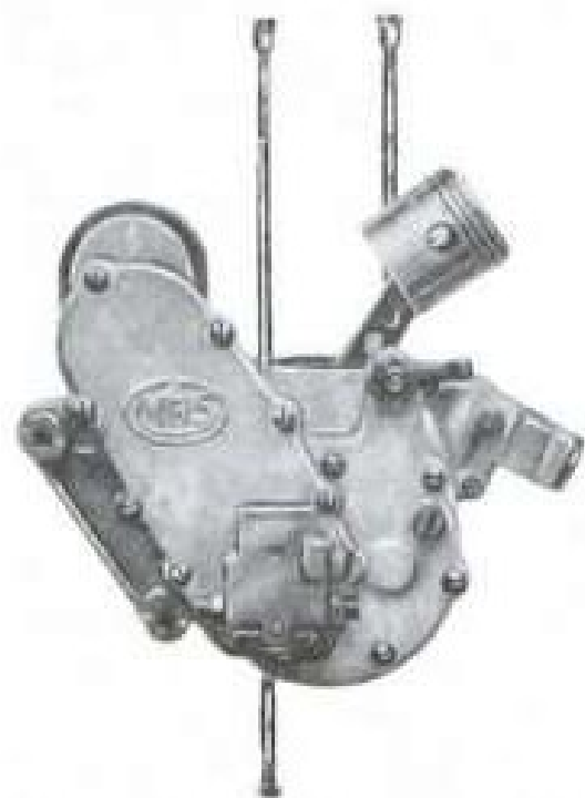
Il motore senza cilindro e senza la testa. Da notare la facilità e rapidità di smontaggio di questi organi e l'accessibilità per la verifica delle parti interne.
