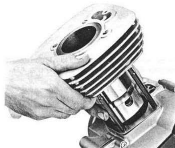
Fig. 44 Rimozione del cilindro Cylinder removal
