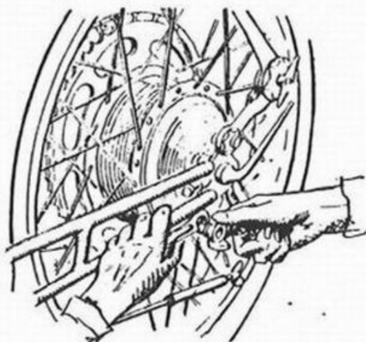
Fig. 43 - Verificare che le bielle di ancoraggio si innestino bene nei rispettivi pomoli
