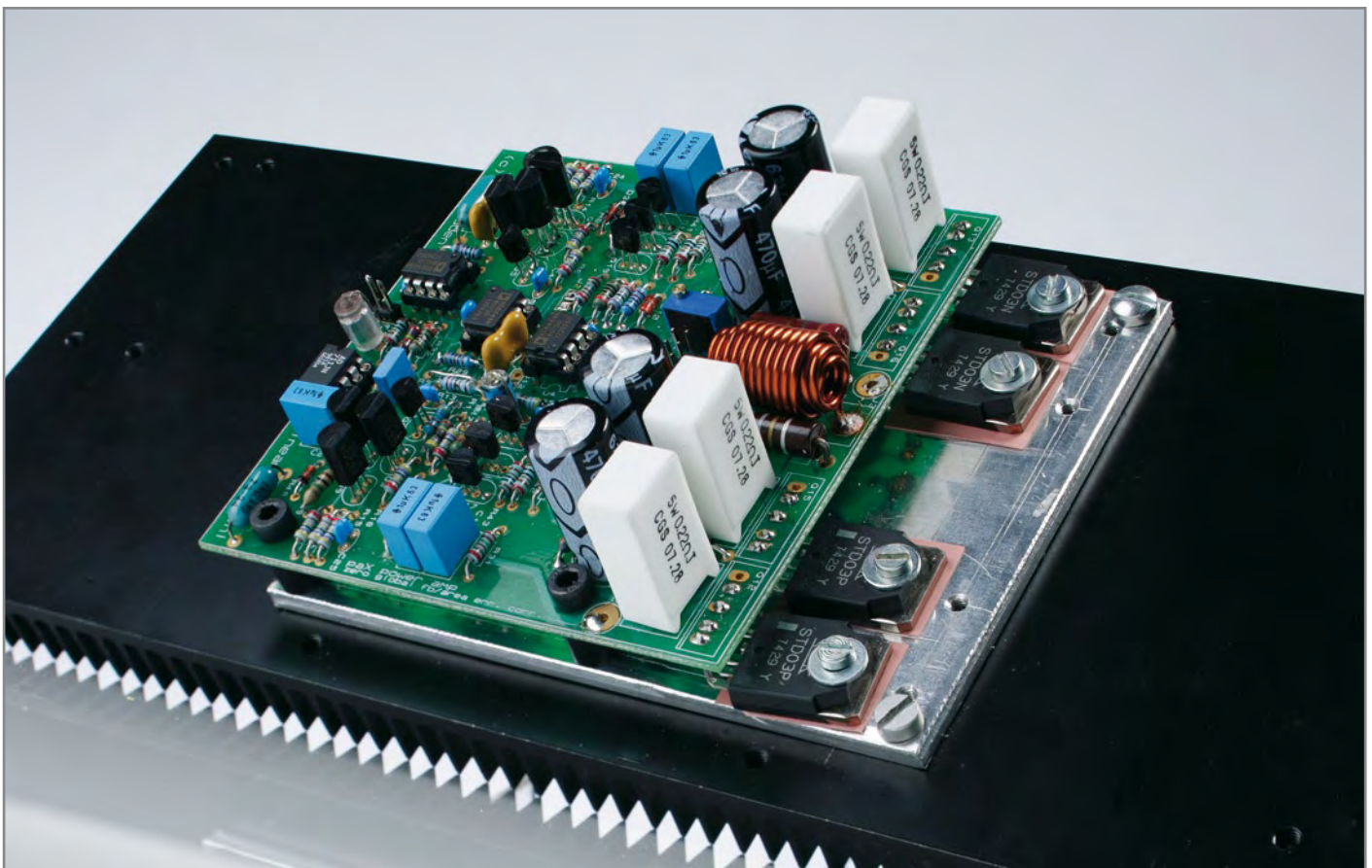
Figuur 10. De opgebouwde versterker-module op z'n koellichaam.
