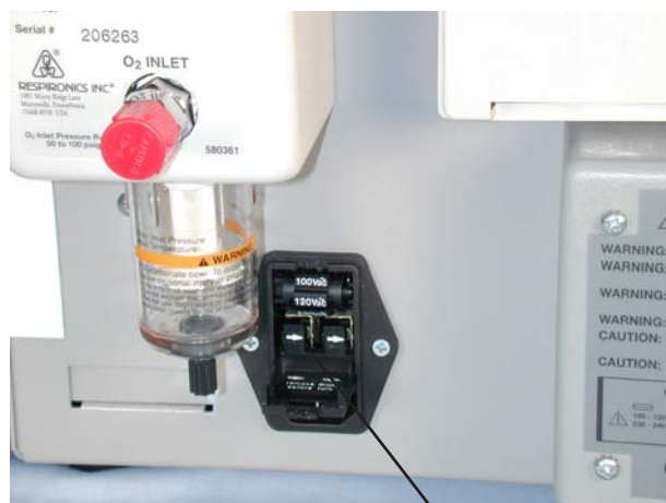
Emplacement des fusibles
