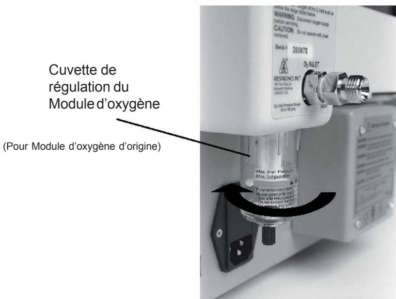
Figure 5-3 Dépose de la cuvette de régulation du Module d'oxygène
