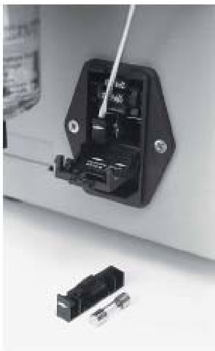
Figure 5-6 Remplacement des fusibles
