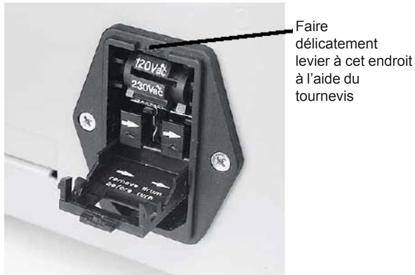
Figure 5-5 Ouverture du capot du porte-fusibles
