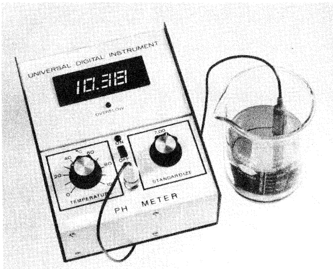
Fig. 7-10. Digital pH meter using a 3130 op amp.
