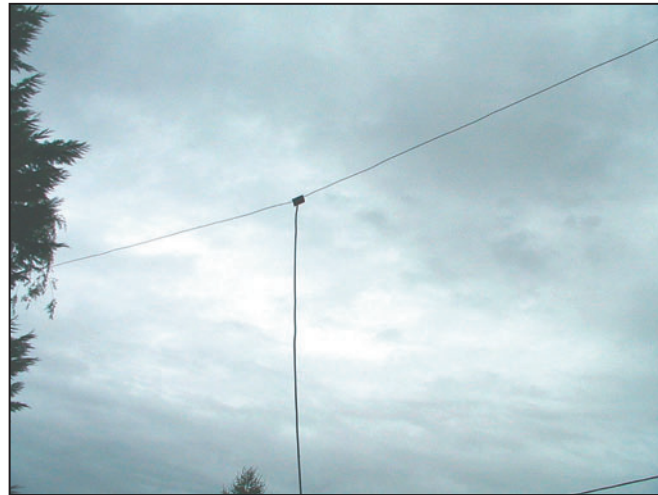
1 - Un doublet 21 MHz expérimental.
