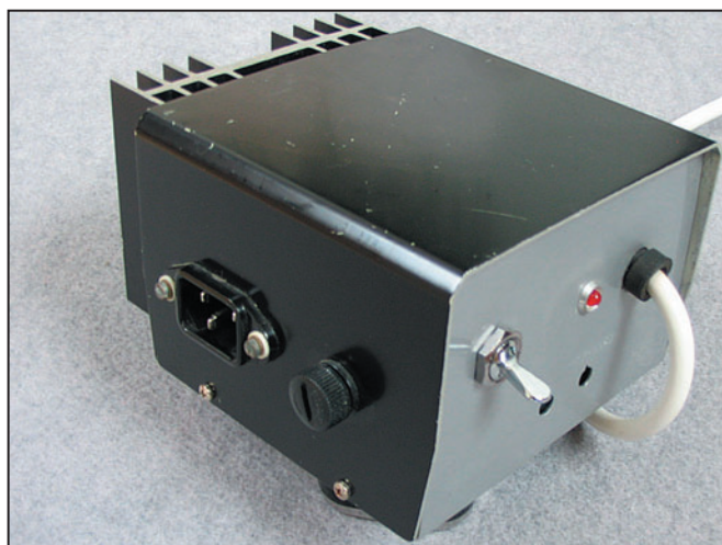
17 - L'alimentation haute-tension et chauffage, déportée du récepteur.
